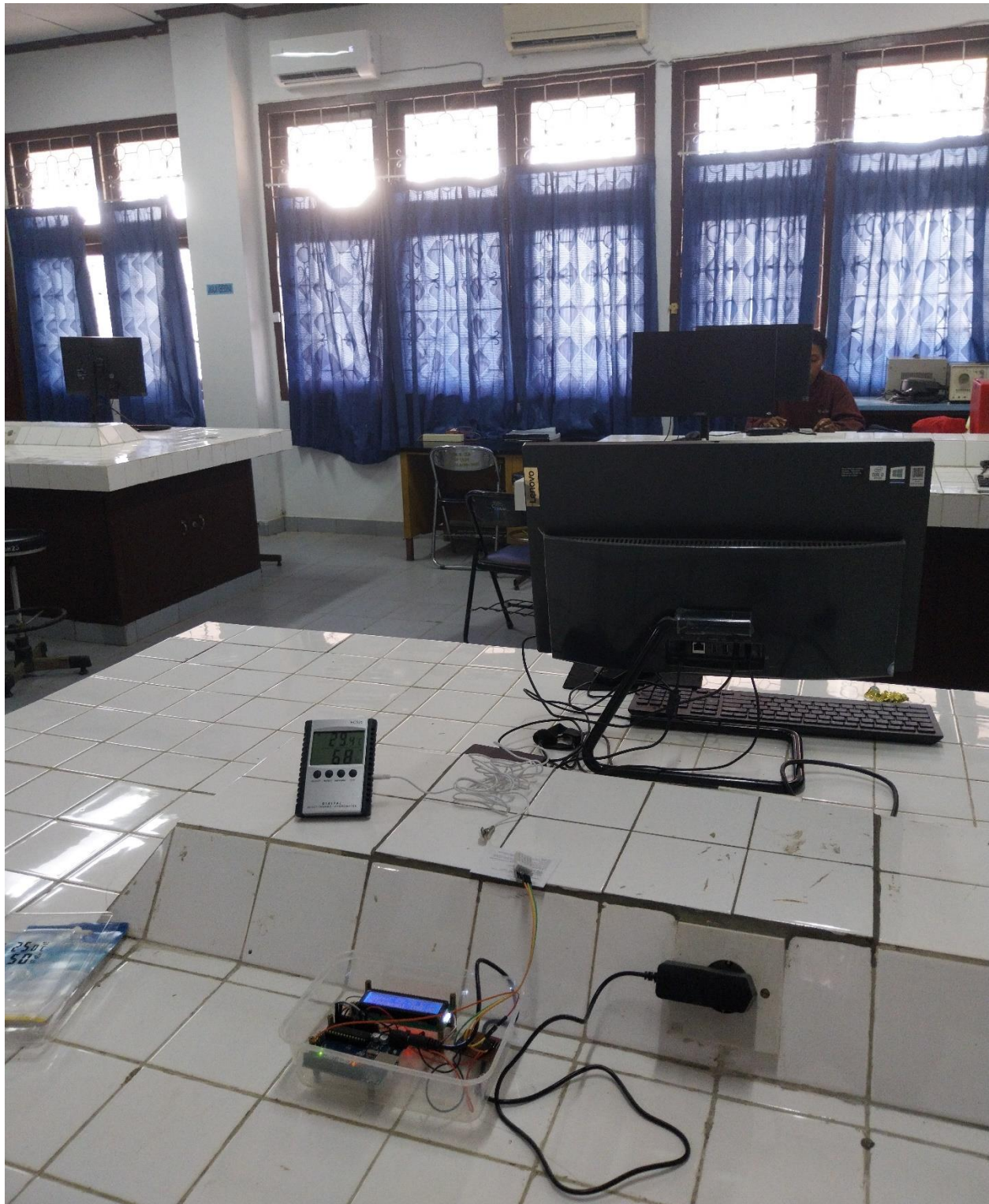
Lampiran 2. Foto Alat Ukur Suhu dan Kelembapan menggunakan sensor DHT22 berbasis Arduino UNO
