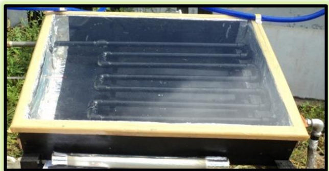
Gambar 2. Desain sistem pemanas air energi matahari dengan kolektor 7 pipa besi (data primer)
