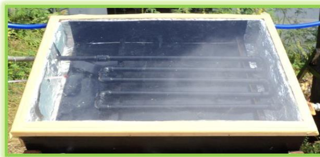
Gambar 1. Desain sistem pemanas air energi matahari dengan kolektor 5 pipa besi (data primer)
