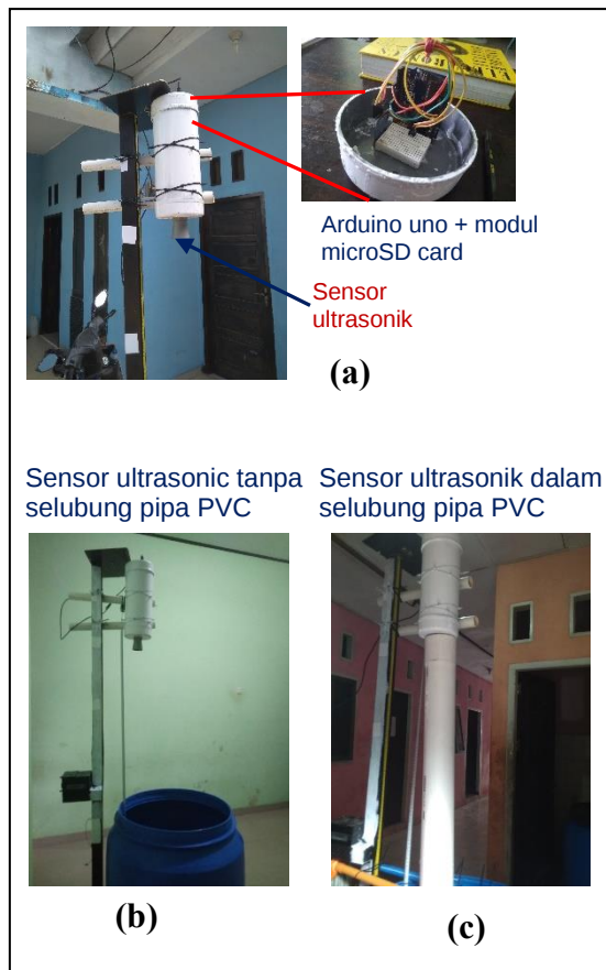
Gambar 3. Foto realisasi alat ukur ketinggian permukaan air yang dikembangkan: (a) tampilan fisik alat; (b). Sensor ultrasonik tanpa selubung pipa PVC; (c). Sensor ultrasonik di dalam selubung pipa PVC.
